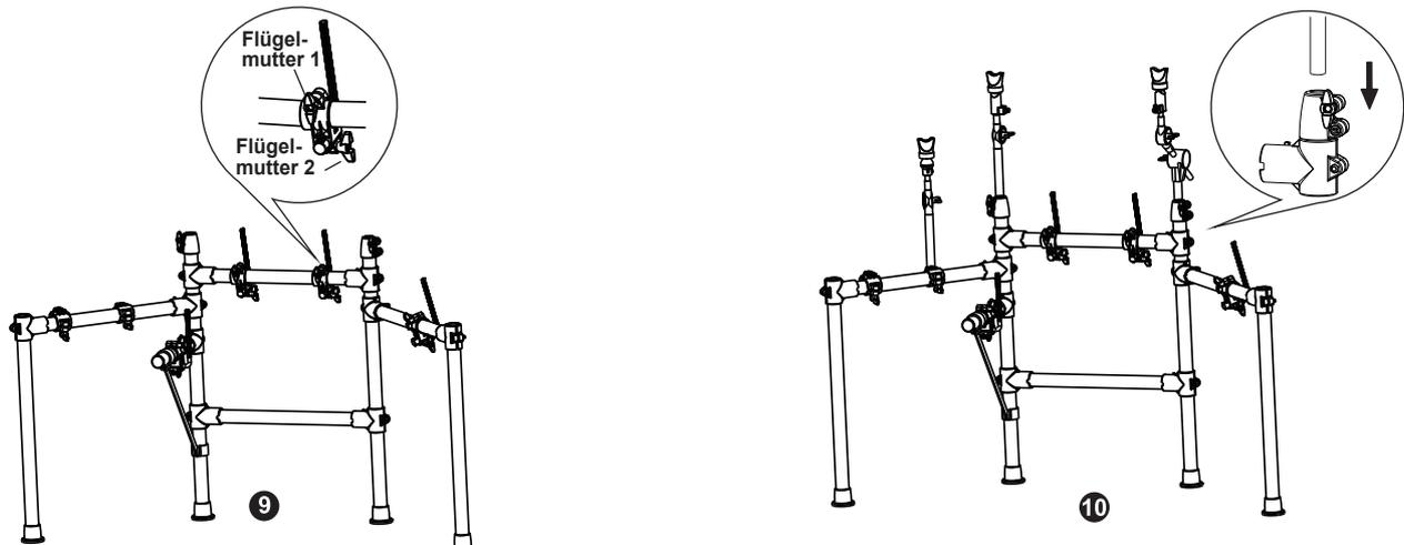
9. Befestigen Sie die Pad-Stäbe an den Stabhalterungen der Mittelstange 1, des Seitenarms (L2) und Seitenarms (R) und ziehen Sie die entsprechenden Flügelmuttern 1 fest an.
