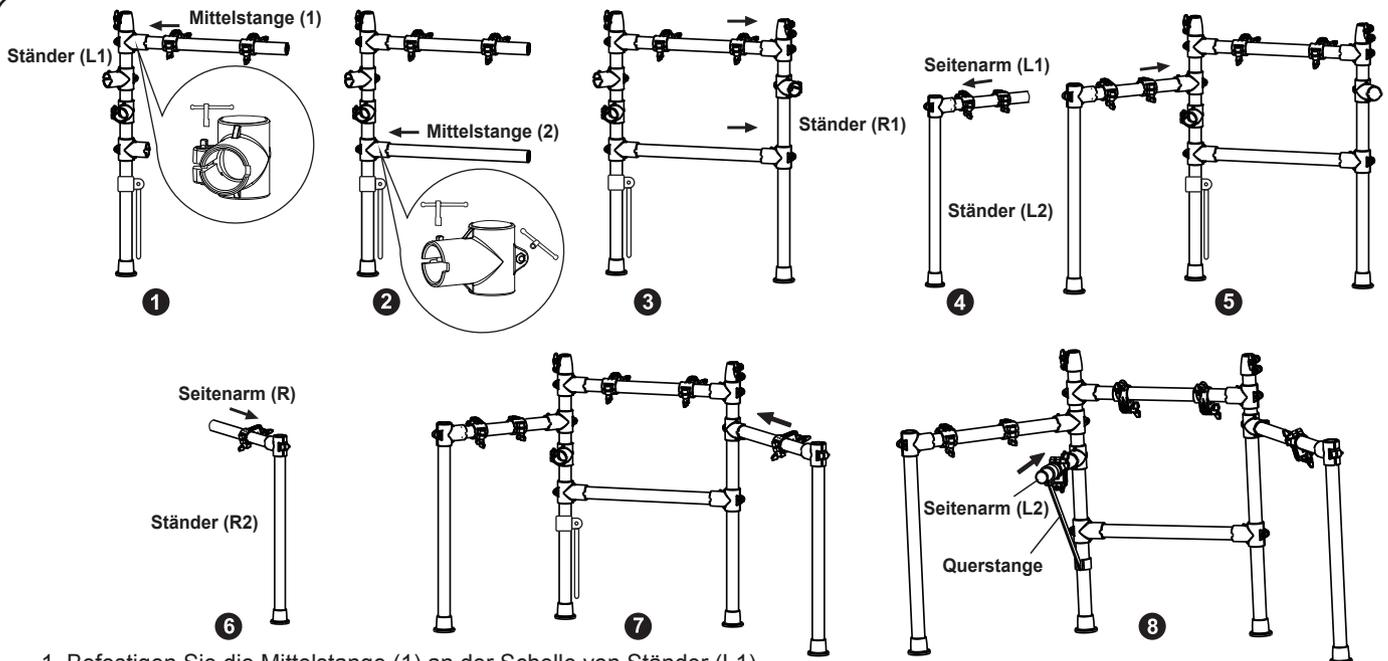
1. Befestigen Sie die Mittelstange (1) an der Schelle von Ständer (L1).
